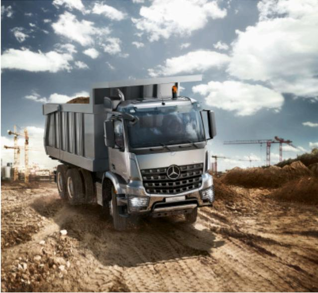
Erhöhter Schutz der Hauptscheinwerfer vor Beschädigungen durch Steinschlag, Äste etc., besonders beim Einsatz auf Baustellen und Schlechtwegstrecken.
