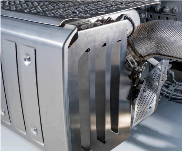
Die Stirnseite der Abgasbox beim Motor 47X kann kostengünstig mit einem Abschirmblech nachgerüstet werden.
